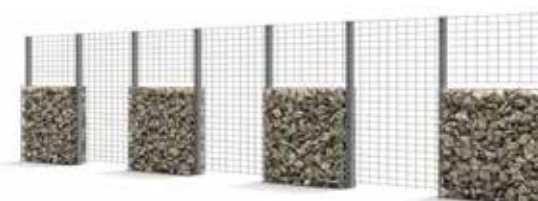
Combinaison de panneaux de clôture avec des modules de proportions variables, qui relient les gabions à la clôture.
