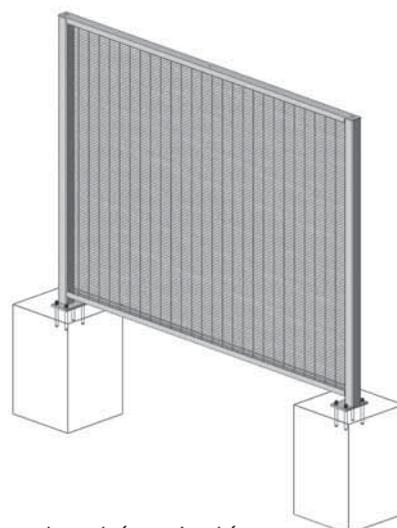
*Fixation sur plots béton isolés*
