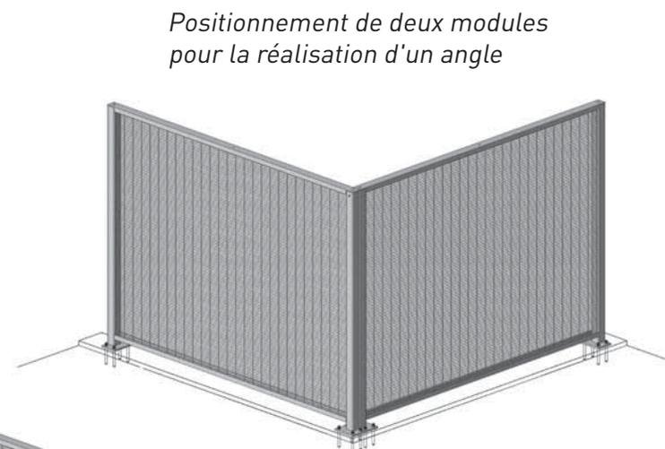
*Positionnement de deux modules pour la réalisation d'un angle*
