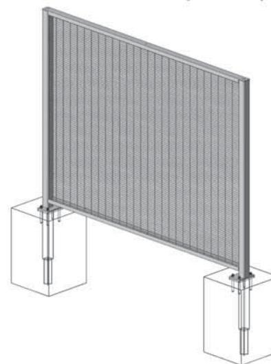
*Fixation par pieds de scellement dans des plots béton isolés*
