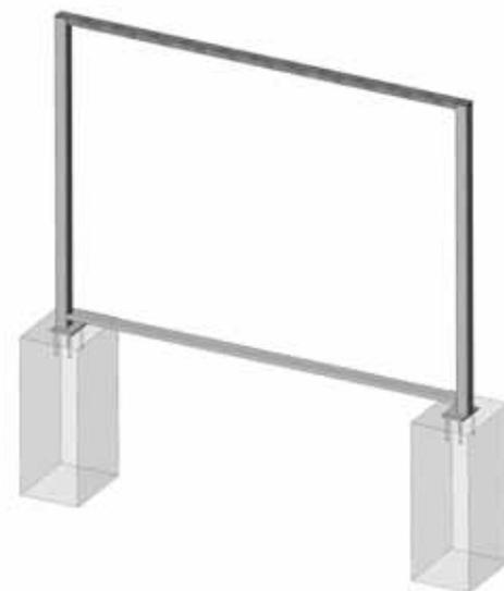
*Fixation sur plots béton*
