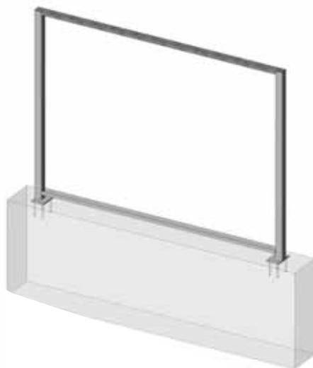
*Fixation sur longrine ou dalle béton*
